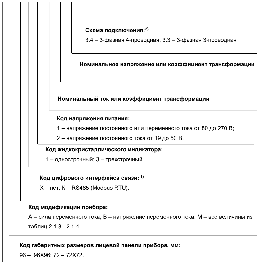
Рисунок 1.2.1 – Структура кода полного условного обозначения приборов серии КС
